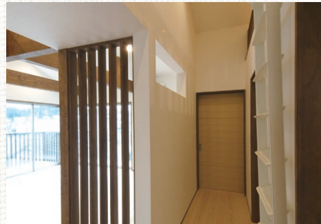
適度に壁を抜くことで通風を促します
